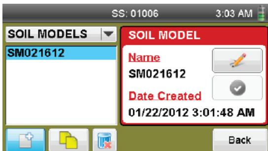
12. Para continuar con la construcción de un modelo de suelo, asegúrese de que su nombre esté seleccionado (resaltado en azul) a la izquierda. Al seleccionar este modelo de suelo en particular, cualquier prueba que se efectúe mientras dicho modelo esté seleccionado, se vinculará a él. Tenga en cuenta que si no se selecciona modelo de suelo alguno, las pruebas no podrán efectuarse.
