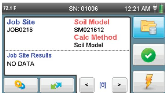
**NOTA:** Si el EDG está apagado y se transporta a un lugar para ensayo, cuando se encienda, se utilizará por defecto el último Modelo de Suelo/ Proyecto seleccionado con el que usted trabajó, que lo devolverá a la pantalla anteriormente mostrada.
