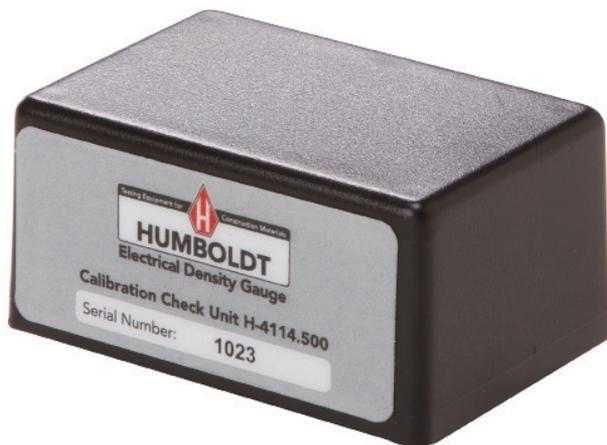
Oprima la tecla SETUP del teclado para abrir el menú de configuración. Seleccione la opción "Calibration Check". Aparecerá la siguiente pantalla. Siga las indicaciones. Antes, conecte la caja de verificación en el sensor de suelo y ambos al puerto del sensor de suelos del instrumento.
