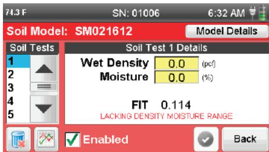
Seleccione densidad húmeda presionando en la respectiva celda amarilla. Aparecerá un teclado para introducir el valor respectivo de la primera prueba por método tradicional. Cuando se haya introducido el valor, pulse el botón Seleccionar
