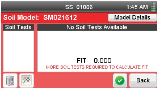
10. En esta pantalla, presione el botón Detalles del Modelo
