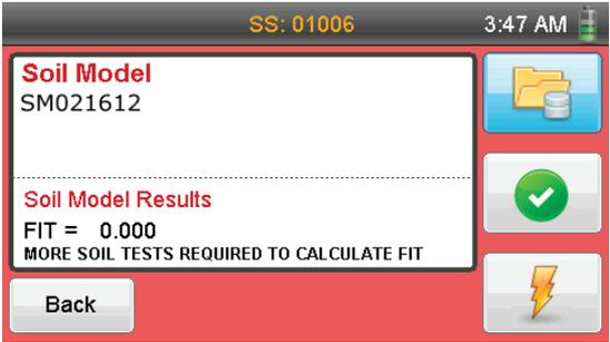
**NOTA:** Si el EDG está apagado y se transporta a un lugar para ensayo, cuando se encienda, se utilizará por defecto el último Modelo de Suelo/ Proyecto seleccionado con el que usted trabajó, que lo devolverá a la pantalla recién mostrada.
