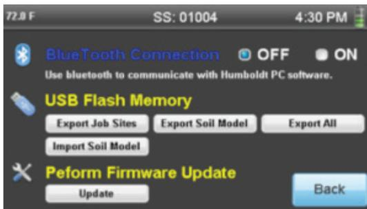
El EDG cuenta con tecnología Bluetooth. Si su computadora trabaja con hardware para Bluetooth, usted puede acceder a los datos en su EDG y transferirlos a su computadora para su utilización con el Software EDG. Para importar los datos a su computadora vía Bluetooth, encienda la conexión a Bluetooth. Esto es posible, presionando ON, próximo a la sección Bluetooth Connection.
